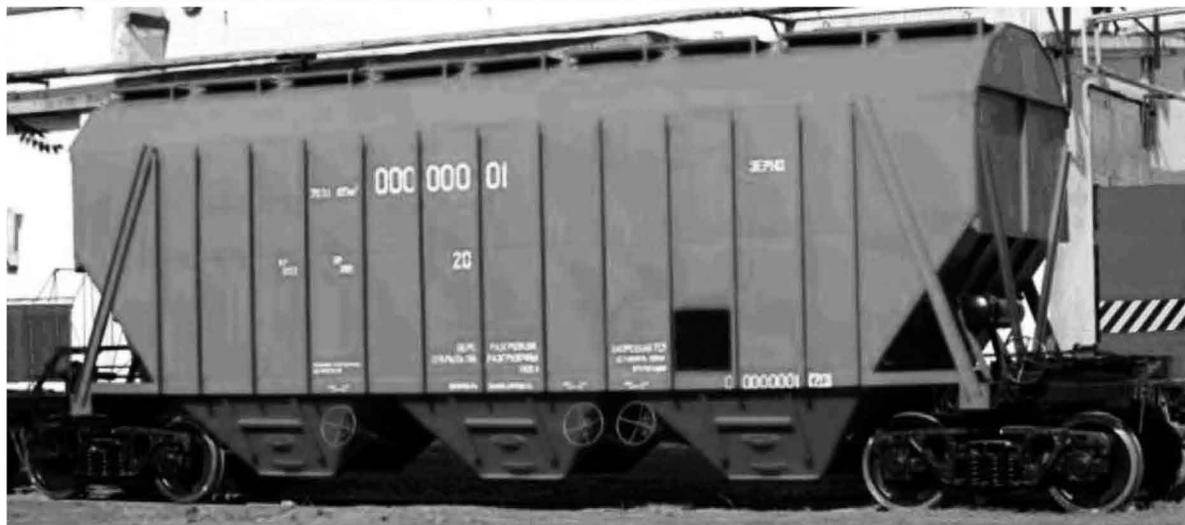
Вагон-хоппер модели 19-9950- четырехосный цельнометаллический крытый вагон с четырьмя загрузочными и шестью разгрузочными люками.
